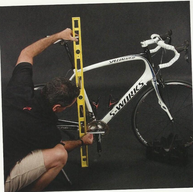
Sadelns position ("set-back") sätts in i förhållande till lodlinjen från vevlagrets centrum.
